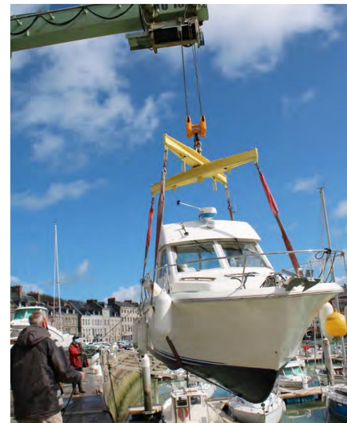
Un grutage (montée + descente) par an est compris dans la location d'un emplacement bateau dans le port. Cette opération minutieuse, réalisée par l'équipe via l'une des deux grues de 5 et 16 tonnes, permet de sortir le bateau de l'eau afin de réaliser diverses opérations de maintenance et d'entretien sur la zone de carénage puis de le redescendre.
