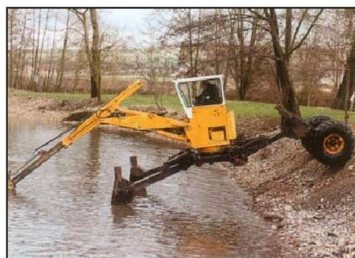
Curage d'une mare à l'aide d'une « pelle araignée » qui permet d'atteindre le centre de la mare sans la vidanger ou détériorer les berges. (Source : AREHN)
