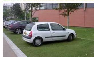
Exemples de parking permettant l'infiltration de l'eau directement là où elle tombe : principe d'hydraulique douce (Source : Ecoveg)
